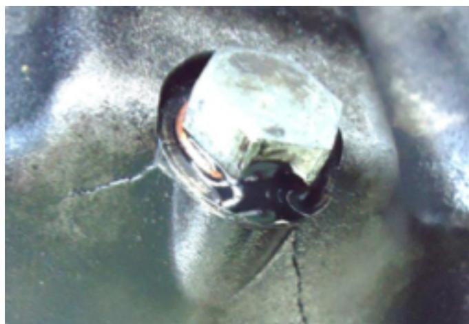
*Ejemplo de **exceso de apriete** en el tornillo de drenaje de aceite provocando que el cárter, al ser de aluminio, se rajara quedando totalmente inservible*
