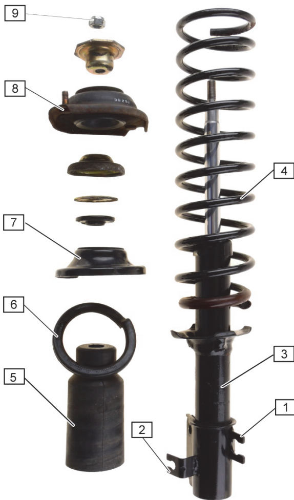
Abb./Fig 2: Stoßdämpfer mit Anbauteilen / Shock absorber with attachments / Amortisseur avec supplément / Amortiguador con piezas auxiliar
