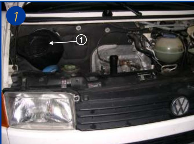
L'élément filtrant est situé sous le capot moteur dans la bouche d'aération coté passager (voir flèche 1).
