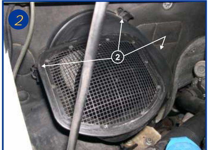
Ouvrir le boîtier filtrant en actionnant les 3 fermetures et retirer ce boîtier (voir flèche 2).
