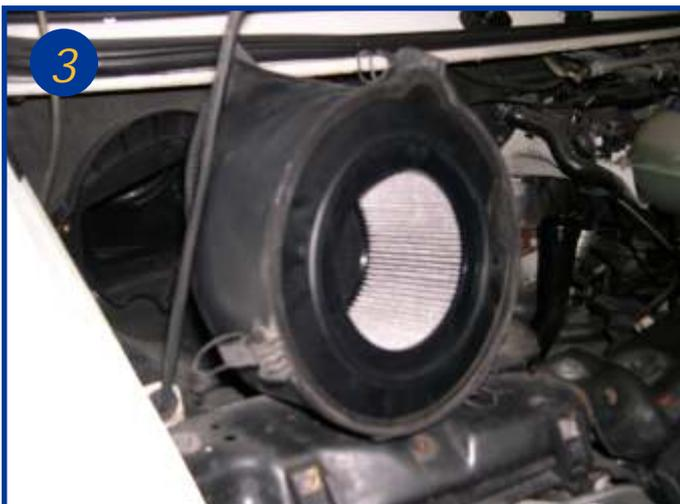
Retirer l'élément filtrant et son couvercle d'appui du capot porte filtre.
