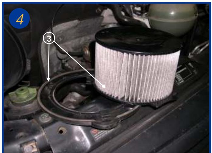
Dissocier l'élément filtrant de son support en pressant les deux clips plastiques situés sur la plaque support (voir flèche 3). Remplacer l'élément filtrant et le remontage s'effectue alors dans l'ordre inverse du démontage.
