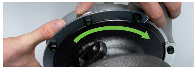
Εικόνα 3: Το περίβλημα μπορεί να προσαρμοστεί στη θέση εγκατάστασης με συστροφή
