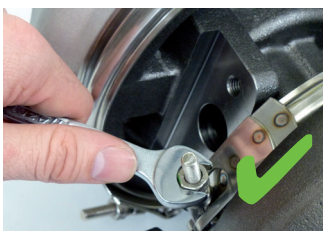
Εικόνα 2: Τα κολάρα σύσφιξης και οι βίδες μπορούν να λασκάρουν για τη ρύθμιση
