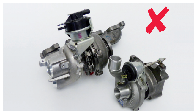
Рисунок 1: Нерегулируемый турбонагнетатель (слева) и регулируемый нагнетатель (справа) — корректировки допускаются только при работе с нерегулируемыми моделями!
