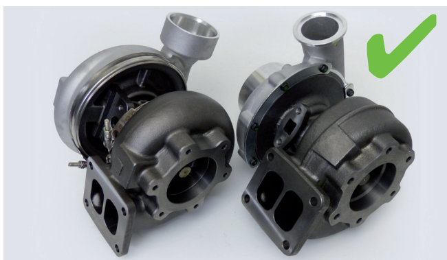
Ilustracja 1: Turbosprężarki nieregulowane (z lewej strony) i sprężarki regulowane (z prawej strony) – dopasowanie jest dopuszczalne jedynie w przypadku modeli nieregulowanych!
