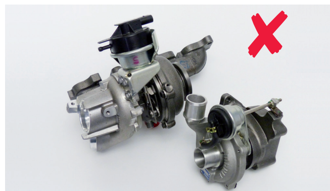
Figura 1: Turbocompresor no regulado (izquierda) y turbocompresor regulado (derecha): ¡solo se pueden realizar adaptaciones en los modelos no regulados!
