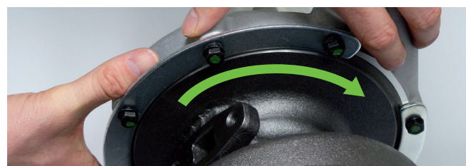
Рисунок 3: Путем разворота можно выполнить пригонку корпуса в месте монтажа
