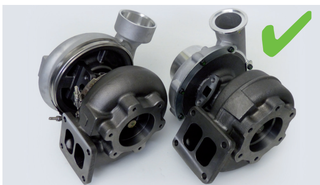
Рисунок 1: Нерегулируемый турбонагнетатель (слева) и регулируемый нагнетатель (справа) — корректировки допускаются только при работе с нерегулируемыми моделями!
