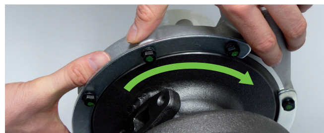
Ilustracja 3: Obudowę można dopasować do położenia montażowego poprzez obrócenie
