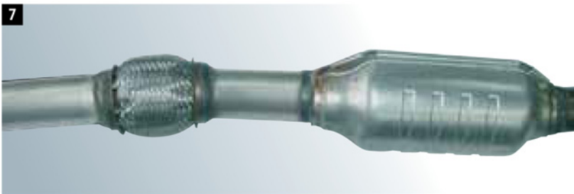
Clevere Reparaturlösung: Neues Flexrohr am „alten“ Bauteil.
