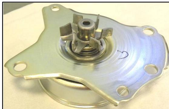
Prima di montare la pompa acqua rimuovere la guarnizione dal basamento motore e pulire la relativa sede prima di apporre la nuova guarnizione.
