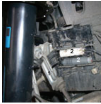
Fig. 2: 1 Halterung für Leitungen / Holder for wiring / Support à câbles / Sujeción para cables 2 Steckverbindungen / Plug connectors/ Fiches de connexion / Conectores
