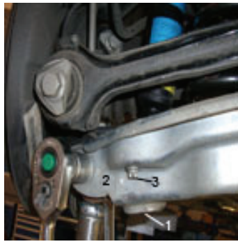
Fig. 8: 1 Befestigungsschraube / Fastening screw / Vis de fixation / Tuerca de fijación 2 Querlenker / Track control arm / Bras transversal / Brazo de dirección transversal 3 Verschraubung unteres Dämpferlager / Screw connection: lower damper bearing / Vissage du palier inférieur d'amortisseur / Tornillería del cojinete inferior del amortiguador
