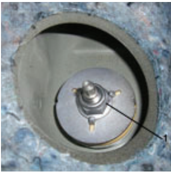
Fig. 7: 1 Kolbenstangenmutter / Piston rod nut / Écrou de la tige de piston / Tuerca del eje del amortiguador
