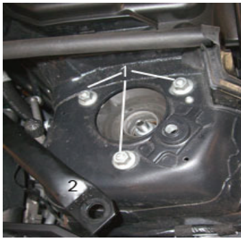
Fig. 4: 1 Befestigungsmuttern / Fastening nuts / Écrous de fixation / Tuercas de sujeción 2 Domstrebe / Dome strut / Barre antirapprochement / Tirante
