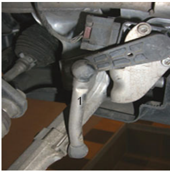
Fig. 1: Leuchtwerten Regelgestänge / Headlight leveling control rod / Tige de régulation de la portée des phares / Varillaje de la regulación de los faros
