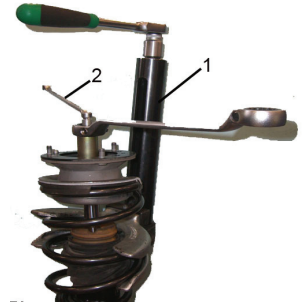
Fig. 6: 1 Federspanner / Spring tensioner / Tendeur de ressort / Tensor de resorte 2 Spezialwerkzeug / Special tool / Outil spécial / Herramienta especial
