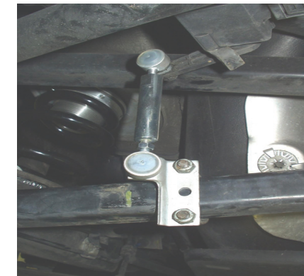
Fig. 6 Leuchtweiten-Gestänge / Headlight leveling rod / Timonerie de réglage de la portée des phares /
