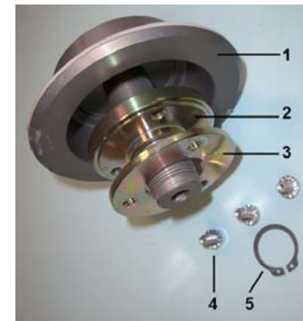
Fig. 7 1 Verstelleinheit / Adjustment unit / Dispositif de réglage / Unidad de regulación 2 Gewindezapfen / Threaded pin / Goupille fileté / Vástago roscado 3 Klemmring / Clamping ring / Anneau de serrage / Anillo afianzador 4 Schrauben / Screws / Vis / Tornillos 5 Segering / Snap ring / Anneau de type Seeger / Anillo de retención
