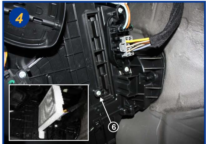
Dévisser la vis de 5,5 mm (6) et ouvrir boîtier filtrant . Procéder au changement des filtres en les plaçant l'un au dessus de l'autre ( voir encadré). Le remontage s'effectue dans l'ordre inverse du démontage.
