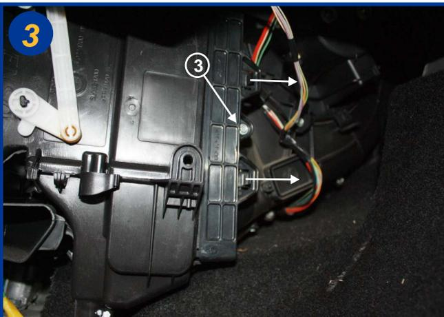
Dévisser la vis hexagonale de 5,5 mm (3) et faire coulisser le couvercle dans le sens de la flèche pour le retirer.
