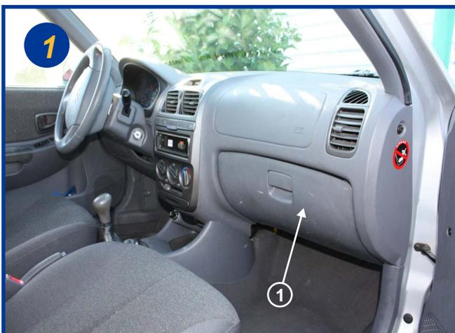
Les filtres d'habitacle sont situés à l'intérieur du véhicule, coté passager derrière la boîte à gants (1).
