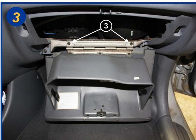
Dévisser les 2 vis cruciformes (3) de la fixation de la boîte à gants sur le tableau de bord.
