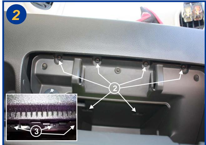
Dévisser les 6 vis cruciformes (2), puis les 3 vis (3) sous la boîte à gants (voir encadré). Retirer le bloc boîte à gants et le mettre sur le coté, il n'est pas nécessaire de débrancher le faisceau électrique.
