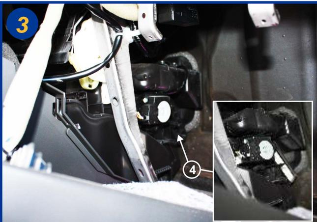
Localiser l'ouverture du boîtier filtrant (4) et retirer le couvercle de celui-ci par le dessous, une patte est prévue à cet effet.
