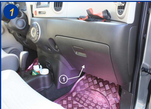
Le filtre d'habitacle est situé à l'intérieur du véhicule, coté passager derrière la boîte à gants en bas de la console centrale (1).
