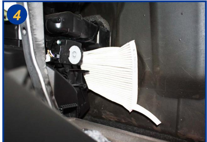
Dégager la patte de dégagement (5) afin d'extraire l'élément filtrant usagé. Il est nécessaire de le déformer pour le retirer et remettre le nouveau. Le remontage s'effectue dans l'ordre inverse du démontage.
