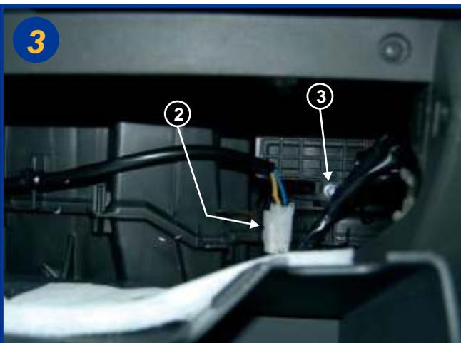
Débrancher le connecteur (2) puis dévisser la vis de 5,5 mm (3) pour extraire le couvercle du boîtier filtrant.
