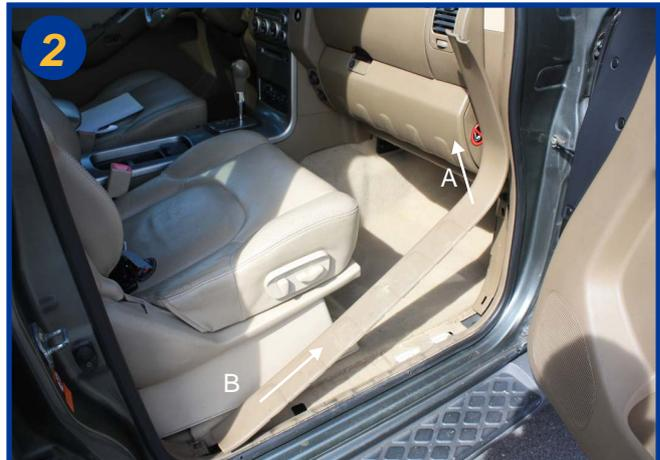
Dégrafer la barre de seuil, pour cela flèche A soulever et flèche B tirer.
