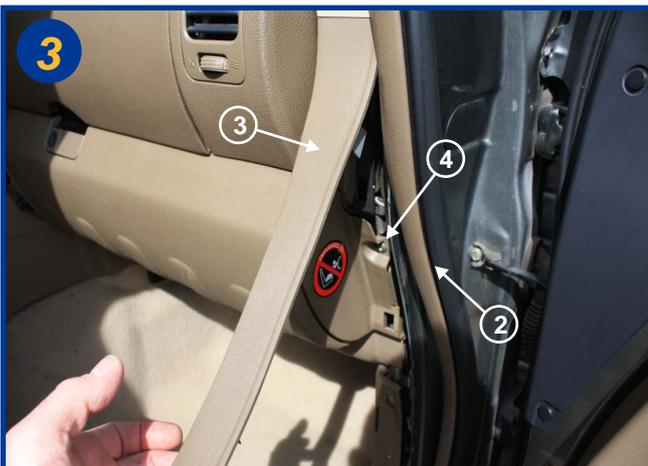
Soulever partiellement le joint d'étanchéité de la porte (2). Puis dégrafer la garniture plastique (3) à droite de la boîte à gants. La retirer.
