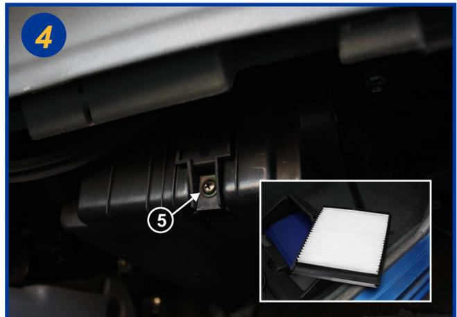
Dévisser la vis cruciforme (5) et retirer le couvercle du boîtier filtrant, procéder au remplacement du filtre.
