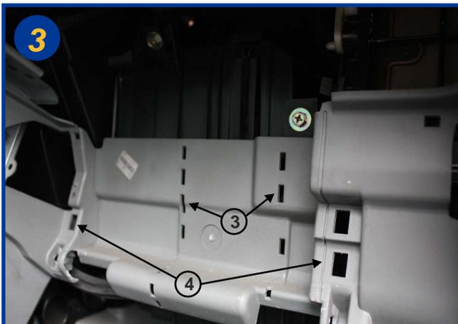
Dans le cas d'un premier changement du filtre, procéder au découpage de la partie centrale en suivant les pointillés (3) et se procurer chez NISSAN la traverse métallique de remplacement qui se fixe avec les trous prévus (4).
