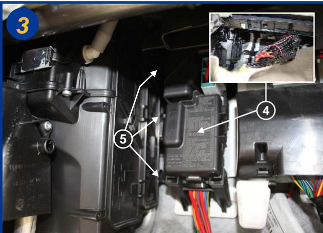
Dégrafer le boîtier des fusibles (4) et le mettre sur le côté.
