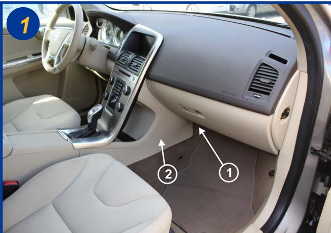
Le filtre d'habitacle est situé à l'intérieur du véhicule, côté passager sous la boîte à gants côté console (1). Dégrafer la paroi plastique de la console centrale (2) et la retirer totalement.
