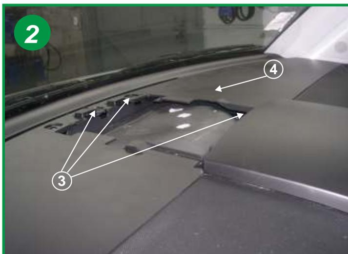
Dévisser les 3 vis de fixation du plastron plastique coté droit (voir flèche 3). Retirer le plastron dans le sens de la flèche 4
