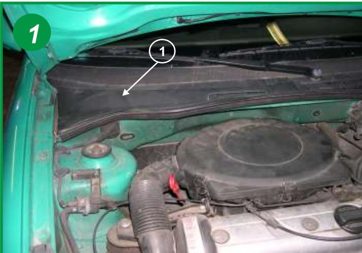
Le filtre d'habitacle est situé sous le capot moteur, sur la baie du pare-brise coté passager (voir flèche 1). Ouvrir le capot moteur.
