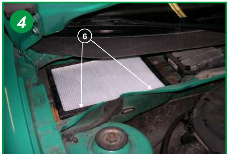
Dissocier l'élément du cadre en actionnant les deux pattes (repère 6) et changer l'élément. Repositionner le cadre à sa place. Le remontage s'effectue dans l'ordre inverse du démontage.
