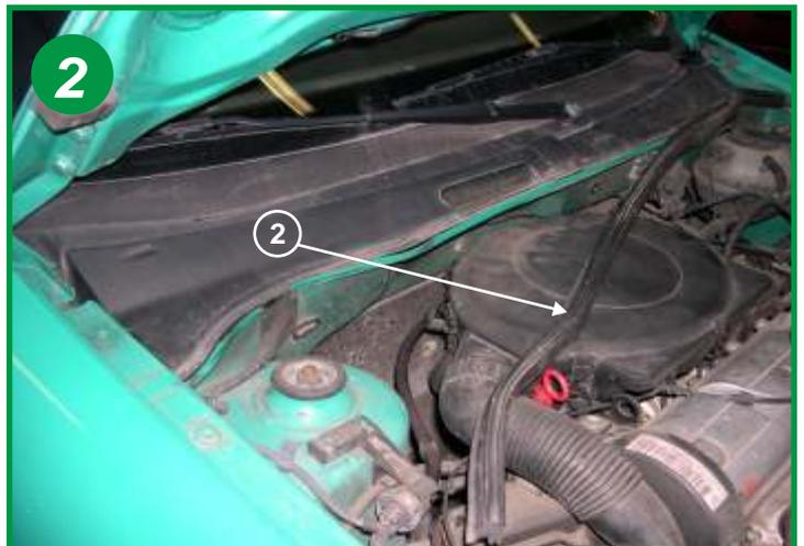
Retirer le joint d'étanchéité moteur sur la moitié (flèche 2).
