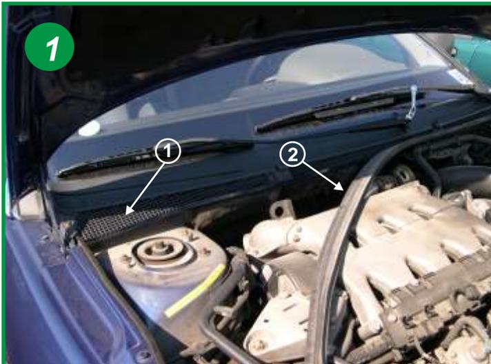
L'élément filtrant est situé sous le capot moteur coté passager (1). Démontez les 2 essuies-glaces et retirez-les. Otez le joint d'étanchéité entre le compartiment moteur et le conduit d'aération (2).
