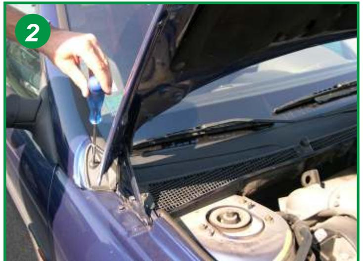
Dévissez les 4 vis torx situées sur les cotés supérieurs droit et gauche du conduit d'aération. Tirez la grille d'aération vers le bas et la déposez sur le pare-brise (la canalisation des gicleurs ne doit pas être enlevée)
