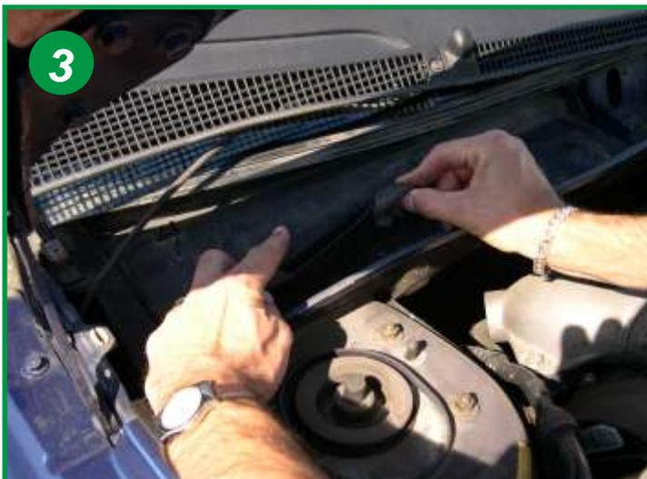
Retirez le couvercle plastique. Pour cela, faites sortir le verrouillage plastique des 2 axes métalliques en exerçant une pression.
