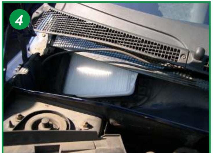
Extraire l'élément filtrant usagé à l'aide des 2 languettes prévues à cet effet et le remplacer (le joint mousse vers le haut). Le remontage s'effectue dans l'ordre inverse du démontage.
