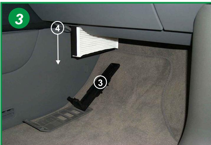
Retirer le couvercle du boîtier filtrant (3) et extraire l'élément filtrant en le tirant vers le bas (flèche 4). Le remontage s'effectue dans l'ordre inverse du démontage.
