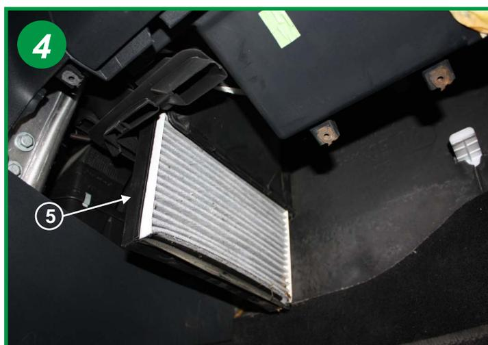
Extraire l'élément filtrant usagé et le retirer de son cadre plastique (5). Procéder à son remplacement en imbriquant les 2 premiers plis dans l'armature du cadre. Le remontage s'effectue dans l'ordre inverse du démontage.
