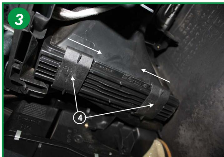
Faire coulisser les 2 guides plastiques (4) dans le sens des flèches et retirer le couvercle du boîtier filtrant.
