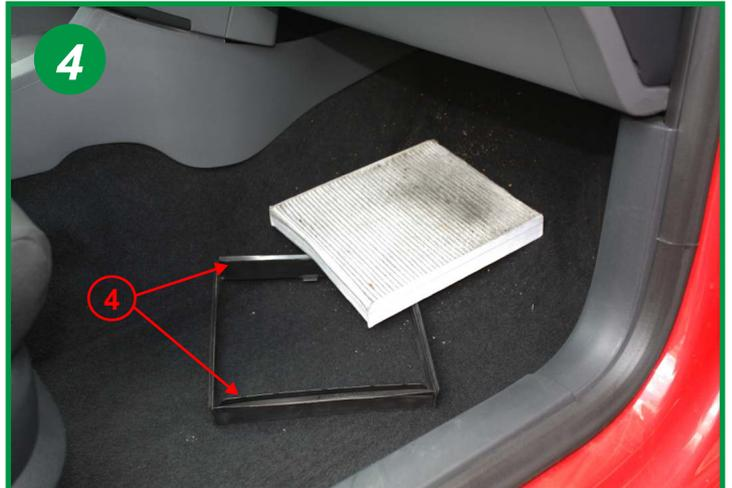
Retirer l'élément filtrant hors de son cadre plastique et le remplacer en imbriquant les 2 premiers plis dans les nervures sur le cadre prévues à cet effet (4). Le remontage s'effectue dans l'ordre inverse du démontage.
