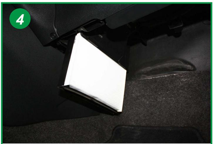
Extraire le filtre usagé par le bas, le retirer de son cadre amovible et le remplacer. Le remontage s'effectue dans l'ordre inverse du démontage.
