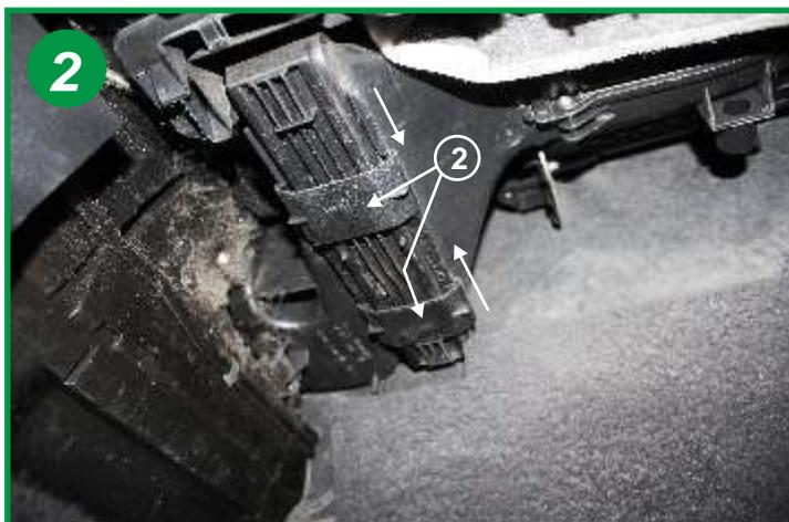
Ouvrir le boîtier filtrant en faisant coulisser les 2 bagues (2) vers le milieu du couvercle (voir flèches). Retirer le couvercle.
