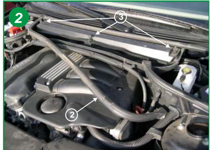
Retirer une partie du joint d'étanchéité du compartiment moteur (voir flèche 2).
