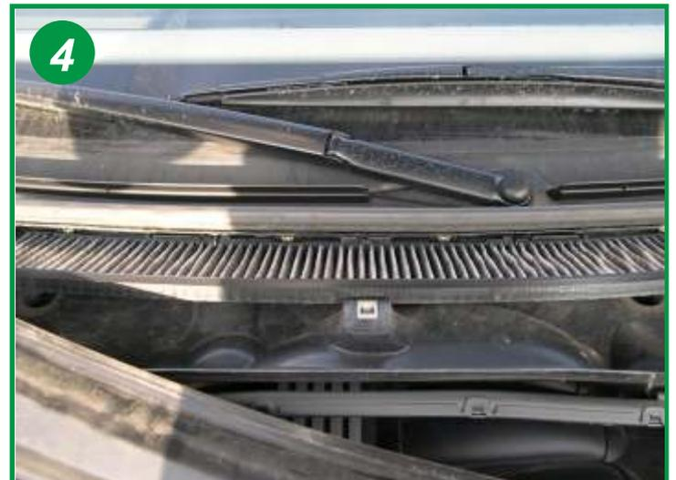
Repositionner le nouvel élément filtrant.
