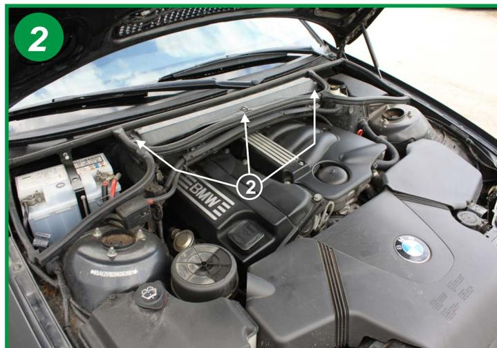
Tourner d'un quart de tour les 3 fermetures à ressort du capot de protection de l'élément filtrant (2).
