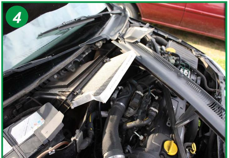
Sortir le filtre et le remplacer. Le remontage s'effectue dans l'ordre inverse du démontage.
