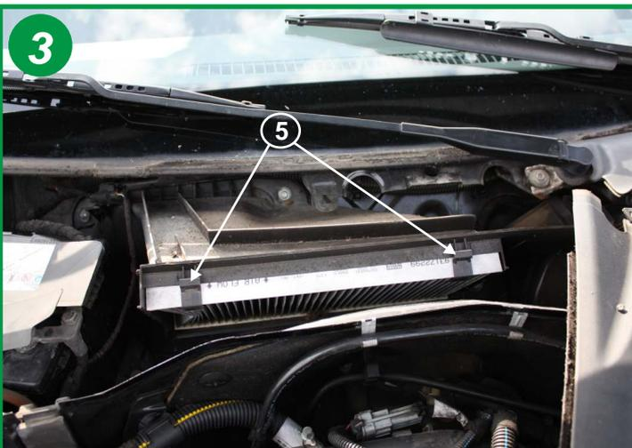
Soulever le 2 fermoirs (5) et extraire l'élément filtrant usagé.
