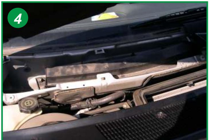
Engager les 2 languettes de l'élément filtrant sous les nervures du cadre en pliant légèrement l'élément pour l'adapter à la courbure. Clipser les agrafes des 2 cotés dans les ergots de blocage du cadre. Le remontage s'effectue dans l'ordre inverse du démontage.
