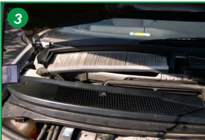
Ecarter au centre les 2 moitiés de la grille d'aération. Retirer la moitié droite de cette grille. Faire basculer les 2 pattes d'encliquetage (coté droit et coté gauche) sur le cadre porte-filtre. Dégager par le haut le cadre porte-filtre afin de retirer l'élément filtrant usagé.
