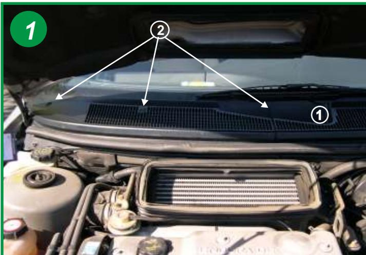
L'élément filtrant est situé dans le boîtier d'aération sous le capot moteur (du côté passager). Déboîter les cache-vis sur l'articulation du balai d'essuie glace droit et retirer celui-ci après avoir dévissé l'écrou hexagonal (1). Retirer les 3 capuchons de protection des vis sur la grille d'aération droite et défaire les vis (2)
