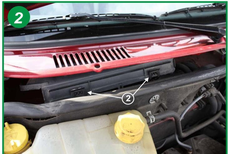
Exercez une pression vers le bas sur les 2 fermetures du boîtier filtrant (2)
