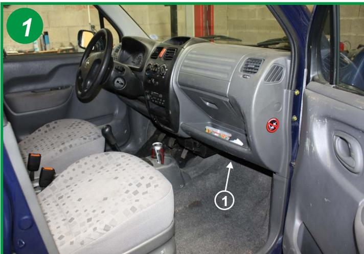
L'élément filtrant est situé dans l'habitacle du véhicule sous la boîte à gants côté passager (1).
