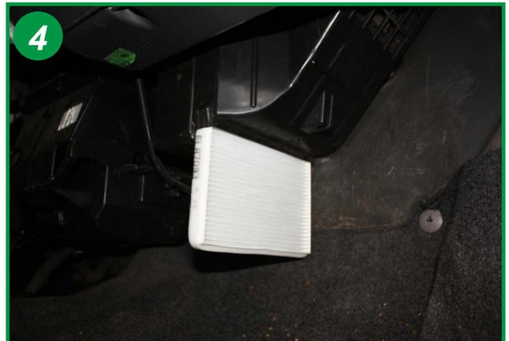
Remplacer l'élément filtrant. Le remontage s'effectue dans l'ordre inverse du démontage.
