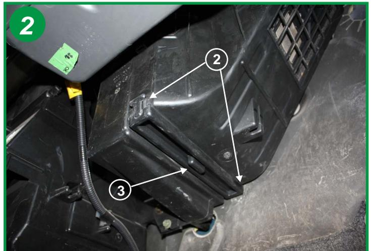
Actionner les deux fermetures en plastique du couvercle sur le boîtier de l'élément filtrant (2) et tirer sur la poignée (3) pour retirer le couvercle.
