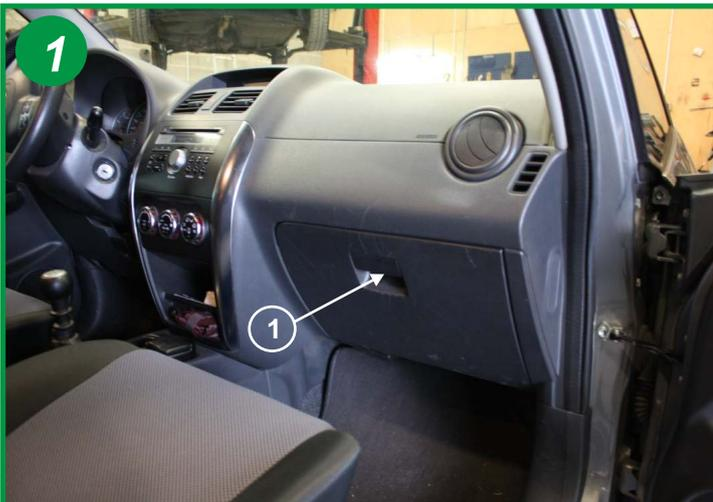
Le filtre d'habitacle est situé à l'intérieur du véhicule, côté passager derrière la boîte à gants (1).
