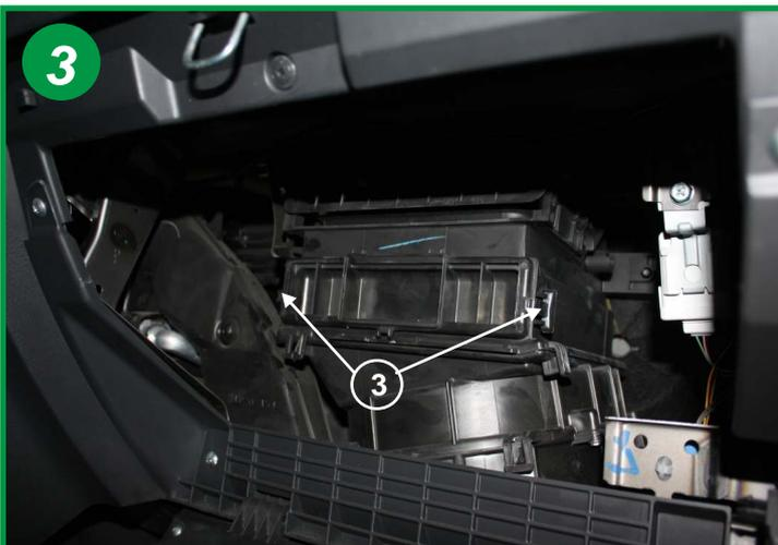
Ouvrir le boîtier filtrant à l'aide des 2 manettes prévues à cet effet de chaque côté du couvercle (3). Retirer le couvercle du boîtier.
