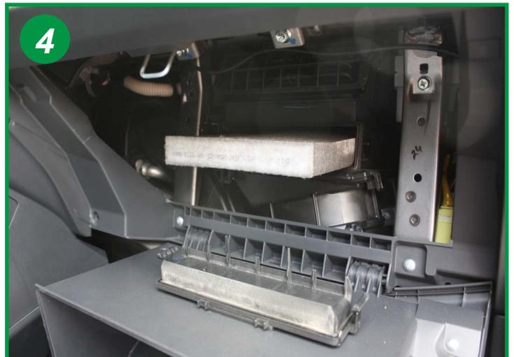
Extraire l'élément filtrant usagé de son boîtier et procéder à son remplacement. Le remontage s'effectue dans l'ordre inverse du démontage.
