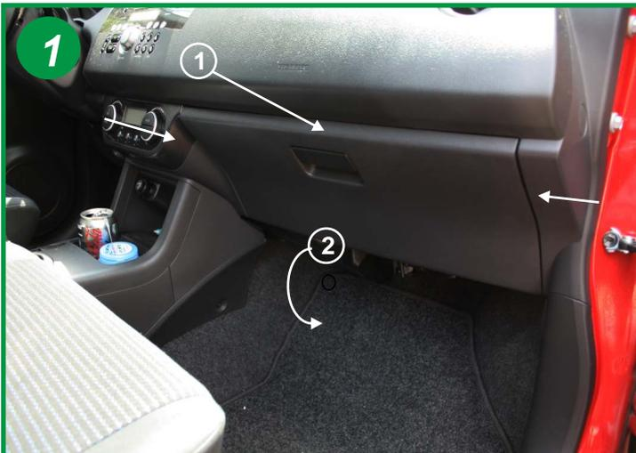
Le filtre d'habitacle est situé à l'intérieur du véhicule, coté passager derrière la boîte à gants (1). Ouvrir cette dernière (2) et presser sur les flancs du tiroir dans le sens des flèches pour dégager les butées arrière.
