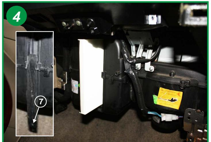
Ouvrir le boîtier filtrant en faisant coulisser le couvercle. (voir encadré) après avoir retiré la vis de fermeture (7).
