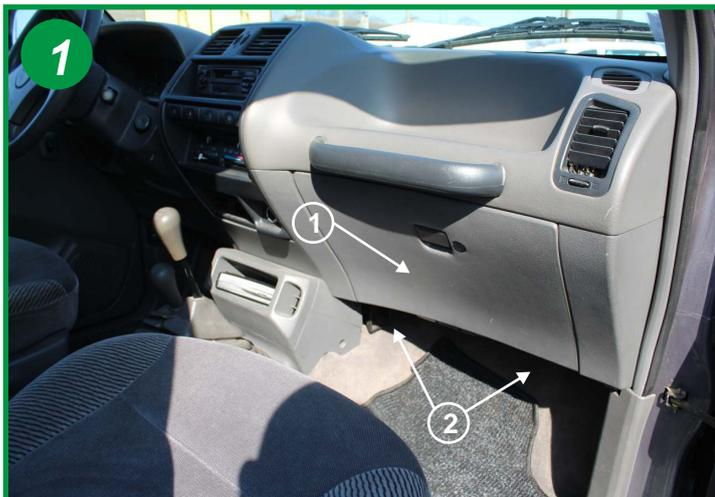
Le filtre d'habitacle est positionné à l'intérieur, côté passager derrière la boîte à gants (1).
