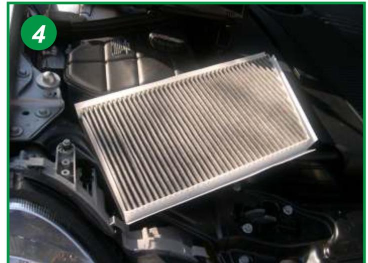
Le nouveau filtre est à replacer comme sur la photo attention de respecter le sens de filtration en positionnant les lèvres d'étanchéité (repère 3) vers le haut, le remontage s'effectue dans l'ordre inverse du démontage.
