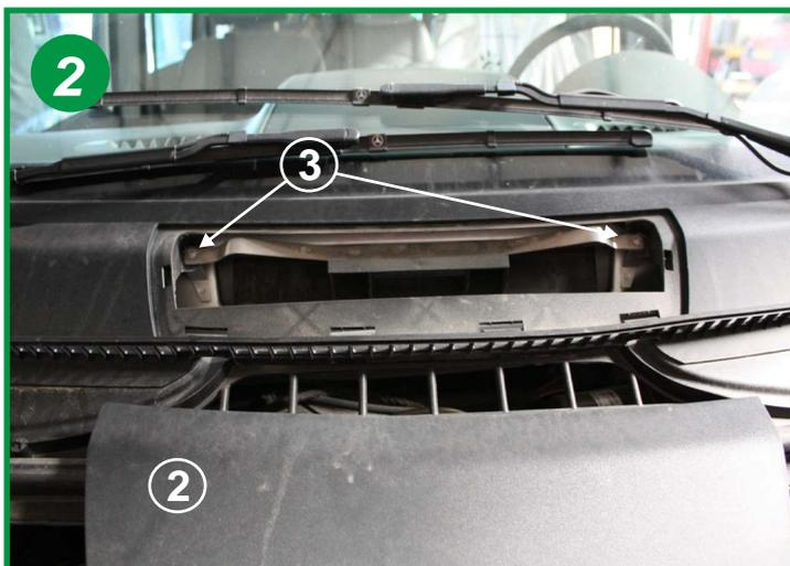
Retirer la trappe qui est juste encliquetée (2), puis les 2 vis Torx (T20)(3) afin de retirer la lame de ressort de maintien.
