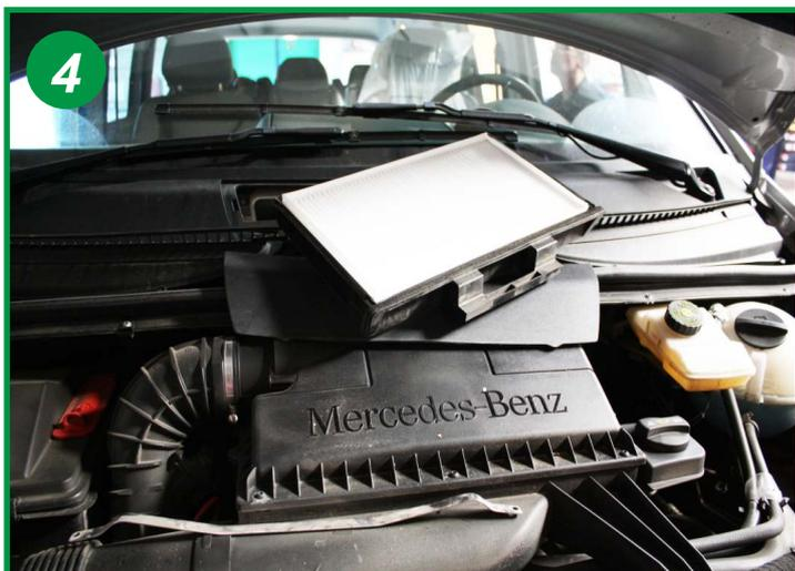
Remplacer l'élément filtrant usagé.
