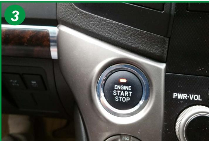
Mettre le véhicule en position « ENGINE ON » sans le démarrer.
