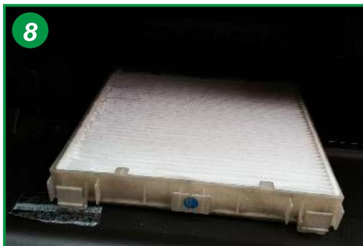
Une fois remplacé, remplacez le tiroir dans son logement couper la climatisation afin que le soufflet se referme. Il ne vous reste plus qu'à replacer la trappe dans le fond de la boîte à gants.
