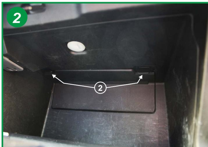
Actionner les 2 loquets (2) situés dans la partie supérieure de la boîte à gants et baisser la trappe vers le bas
