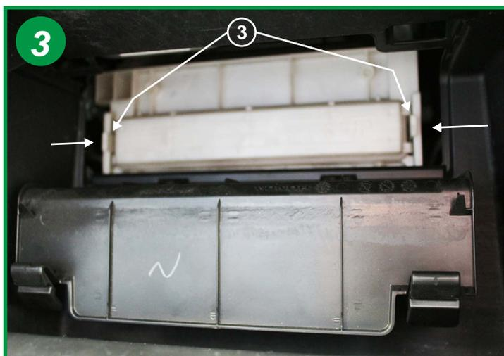
Ouvrir le boîtier filtrant en appuyant sur les fermoirs (3) dans le sens des flèches. Retirer le couvercle.
