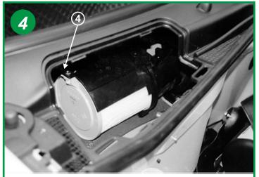
Retirer l'élément filtrant usagé en dévissant l'écrou papillon (voir flèche 4).
