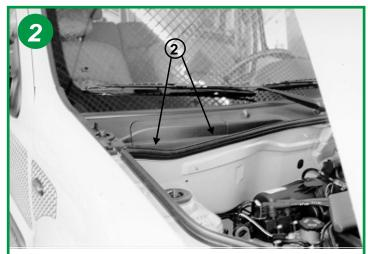
Retirer la grille plastique du conduit d'aération en tirant sur les 2 languettes prévues à cet effet (voir flèche 2).
