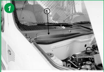
L'élément filtrant est situé sous le capot moteur coté passager. Ouvrir le capot moteur.
