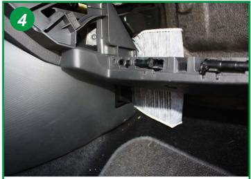
L'entrée du climatiseur étant plus petite que le filtre, le nouveau filtre devra également être déformé. Le remontage s'effectue dans l'ordre inverse du démontage.
