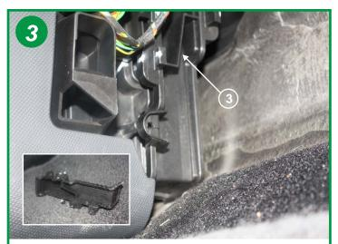
Coté console, localiser le couvercle du boîtier filtrant (3) et le retirer.
