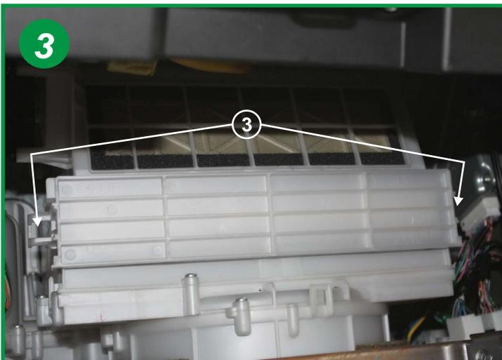
Ouvrir le boîtier filtrant en agissant sur les 2 fermoirs à gauche et à droite du couvercle (3).
