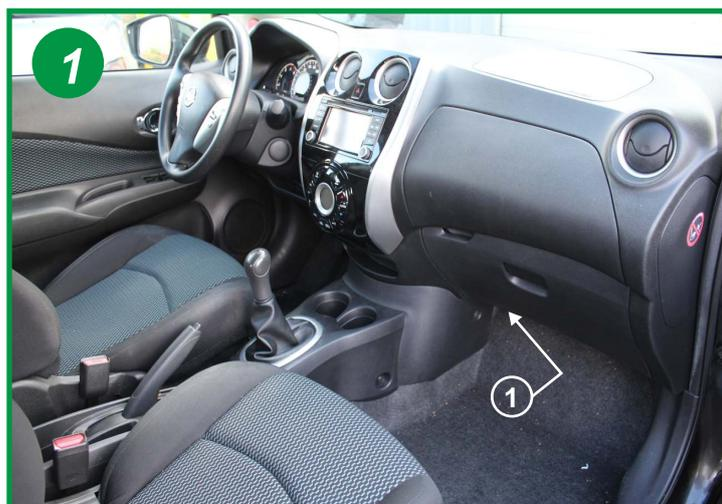
Le filtre d'habitacle est placé à l'intérieur du véhicule, coté passager sous la boîte à gants coté console centrale (1).
