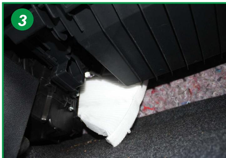
Extraire l'élément filtrant usagé de son logement, il est nécessaire de le déformer pour le retirer, l'orifice d'entrée du climatiseur étant plus étroite que la largeur du filtre.
