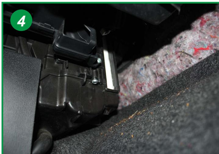
Pour remplacer le nouveau filtre, le faire rentrer en le maintenant en accordéon pour qu'il se déploie à l'intérieur. Veiller à ce qu'il soit bien placé. Refermer le boîtier en y replaçant son couvercle.
