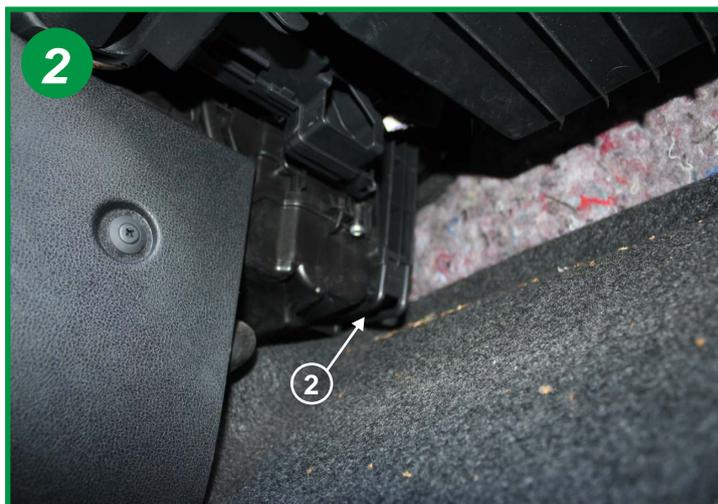
Ouvrir le boîtier filtrant par le dessous (2) en faisant pression sur la patte inférieure du couvercle. Retirer le couvercle.
