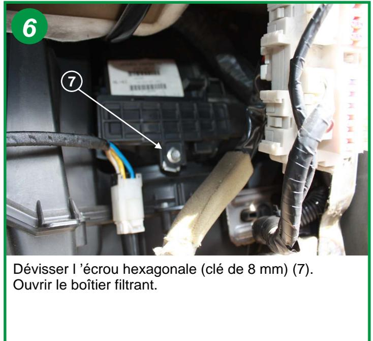
Dévisser l'écrou hexagonale (clé de 8 mm) (7). Ouvrir le boîtier filtrant.
