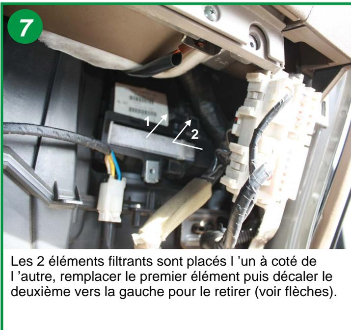
Les 2 éléments filtrants sont placés l'un à côté de l'autre, remplacer le premier élément puis décaler le deuxième vers la gauche pour le retirer (voir flèches).
