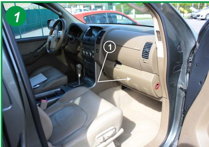
Les filtres d'habitacle sont situés à l'intérieur du véhicule côté passager derrière la boîte à gants (1).
