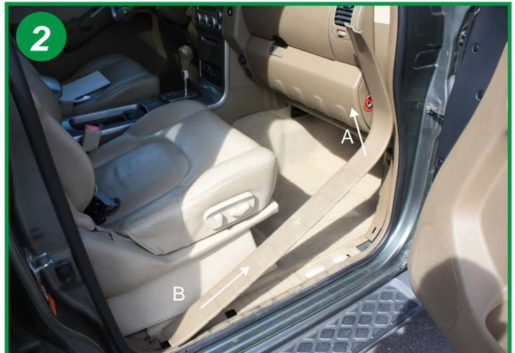
Dégrafer la barre de seuil, pour cela flèche A soulever et flèche B tirer.
