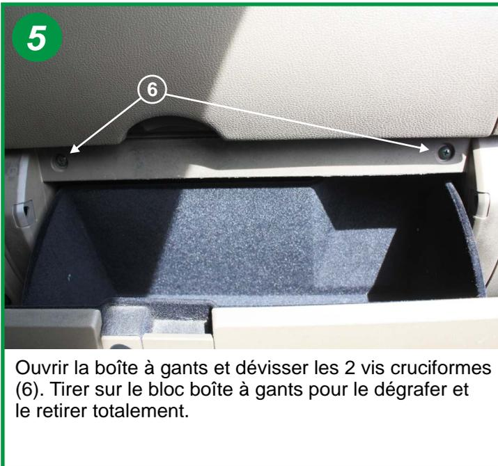
Ouvrir la boîte à gants et dévisser les 2 vis cruciformes (6). Tirer sur le bloc boîte à gants pour le dégraffer et le retirer totalement.
