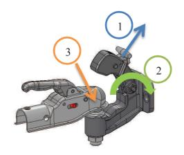
Ouvrir le crochet en tirant sur la poignée 1 et en pivotant l'ensemble de la menotte 2 vers l'arrière.
