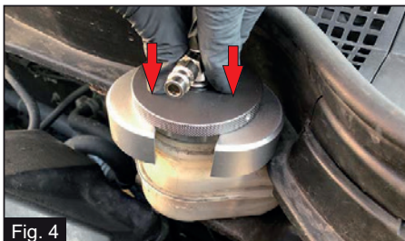
Fig. 4 Adapterdeckel einsetzen und bis zum Anschlag runter drücken
