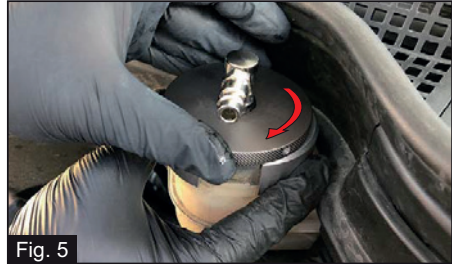
Fig. 5 Arretierarme wieder bis zum Anschlag zusammenschieben und den Deckel durch drehen anziehen.
