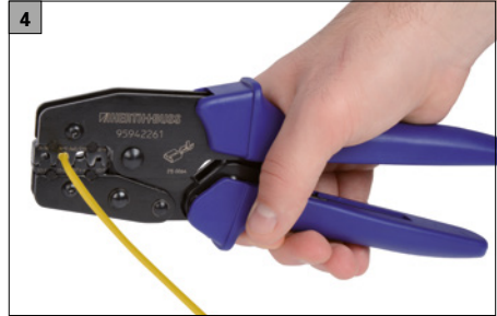
Werkzeug schließen, bis es automatisch wieder öffnet.
