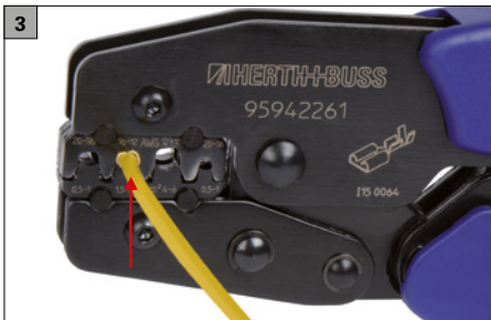
Korrekt abisolierten Leiter in den Kontakt einlegen.
