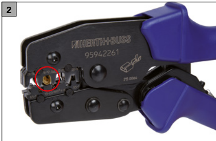
Kontakt in das Profil einlegen und Werkzeug leicht vorschließen, damit Kontakt gehalten wird.
