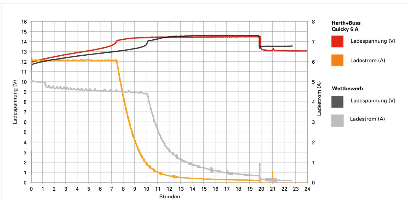
Mit dem Quicky 6 A ist die Batterie schon nach rund 7,5 Stunden nahezu vollgeladen. Mit dem Modell des Wettbewerbers wird dieser Zustand erst nach rund 10 Stunden erreicht. Damit ist die Ladezeit mit dem Quicky 6 A deutlich kürzer. (Batterie mit 68 Ah/12 V)
